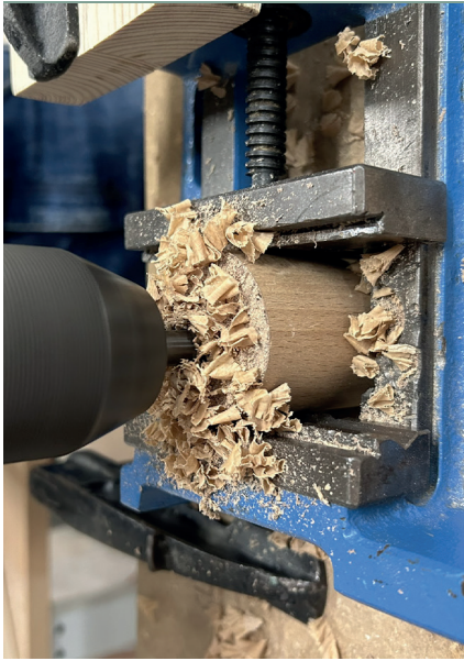
Bohren der Löcher in die Steckverbindung
