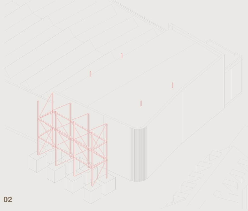
02. Stützen Auf den Fundamenten werden die Stützen montiert. Sie bilden das vertikale Grundgerüst und leiten die Lasten nach unten weiter.
