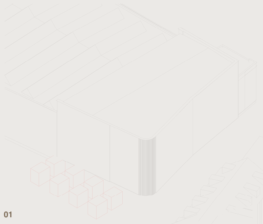
01. Fundament Die Fundamentpunkte werden zuerst gesetzt. Sie bilden die Auflager der neuen Stahlkonstruktion und nehmen die Kräfte aus Stützen und Fachwerken auf.
